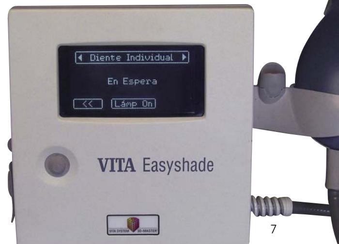
Foto 4: Espectrofotómetro EasyShade -Vita- indicado para la toma de color dental objetiva
